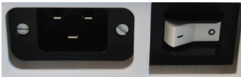
**Figure 6 : Prise électrique et interrupteur principal**
